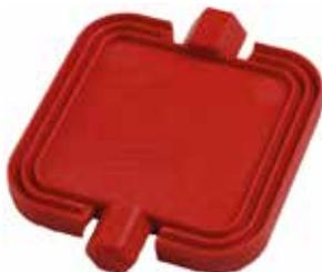
Mit dem **KalibrierTool** bringen Sie das SpeeTube-Heizungsrohr nach dem Schneiden wieder in Form und entgraten es. Die Montage des SpeeTube-Heizungsrohrs ist dadurch in Kombination mit den PushFit-Rohrkupplungen einfach zu erledigen.
